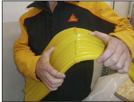
Unión de una Cinta de PVC bien hecha
