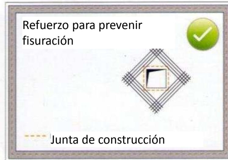
Reducción de fisuras diagonales gracias al acero de refuerzo
