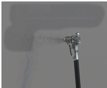
Aplicación con equipo de aspersión de baja presión (airless)
