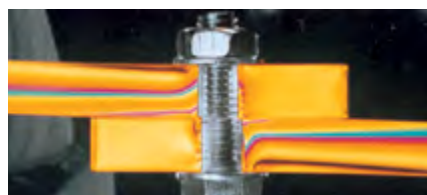
Distribución de esfuerzos, hechos visibles en una fotografía con luz polarizada.
