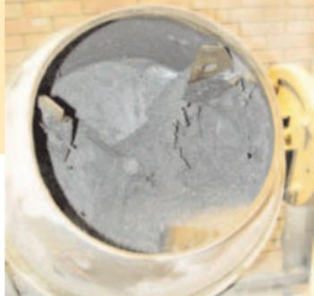
1. Puede adicionarlo a la mezcla del concreto, disuelto en la última porción del agua de amasado, durante la elaboración del concreto o directamente al agua de amasado, preferiblemente antes de incorporar el cemento y los áridos.
