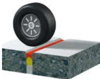
En pisos donde exista tránsito de montacargas de llanta pequeña dura, se debe aplicar un sello de junta epóxico semirígido, **Sikadur®-51 SL**. (Ver cuadro al final del capítulo).
