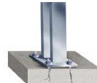
Nivelación inadecuada y mal anclaje de los equipos, fisuración y baja absorción de esfuerzos por vibración de los mismos. Anclaje o fijación de pernos, barras de acero, etc. en elementos estructurales, sin cumplimiento de normas.
