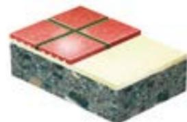
La pega de la baldosas debe ser realizada con un mortero acrílico de alta adherencia, del tipo SikaTop®-121. El sello de las juntas debe hacerse con material resistente al ataque químico presente, con el sistema epóxico de resinas coloreadas Sikafloor®-264 y arenas de cuarzo Sikadur®-506 o con el sistema epóxico con base en resina traslucida Sikafloor®-169 y arenas pigmentadas Sikadur®-510.
