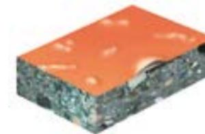
Los piso poliméricos que deben instalarse y ponerse al servicio rápidamente, puede presentar problemas de mala adherencia o ampollamiento y desprendimiento si son aplicados sobre soportes húmedos (>4%) o en concreto con menos de 28 días
