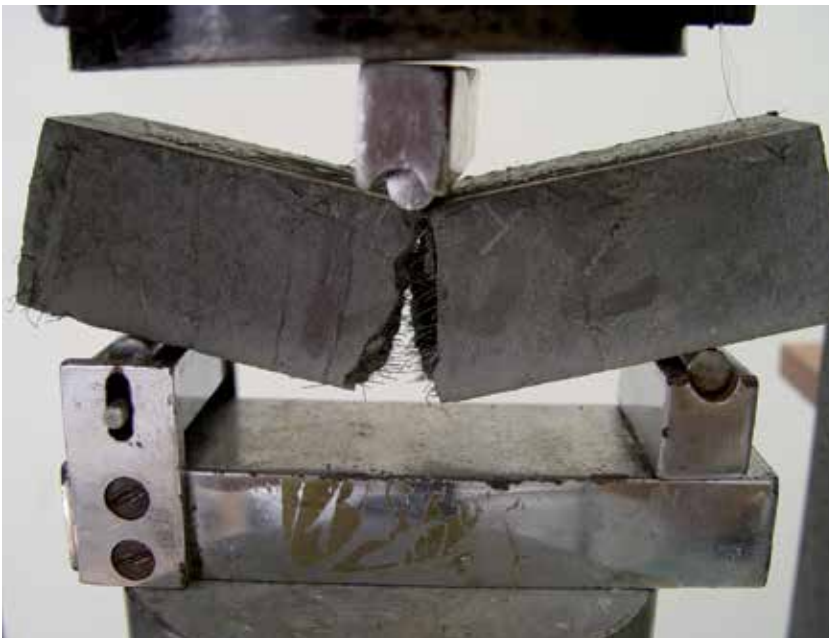
Prueba a la flexión de concreto con fibras para un Módulo de Ruptura de 200 \text{ kg/cm}^2 .
