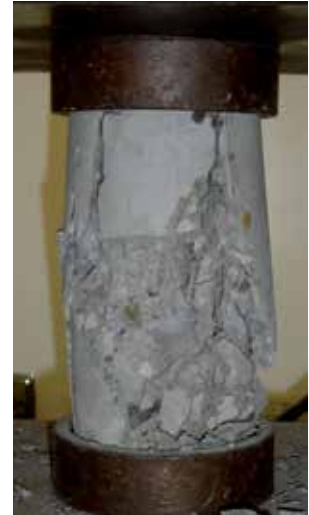
Falla de concreto de ultra alta resistencia, con fibras
