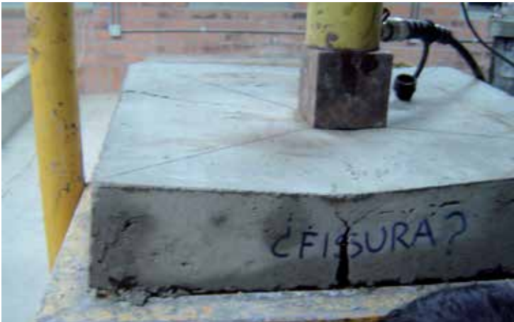
Ensayo EFNARC para determinar la absorción de energía en concreto lanzado. EN (14488-5) ver normas actuales que rigen el empleo de las fibras pág.26
