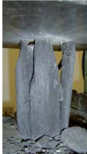
Falla de concreto de ultra alta resistencia, sin fibras
