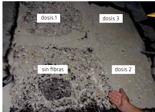
Prueba de resistencia al fuego de paneles de concreto reforzado con fibras [6]
