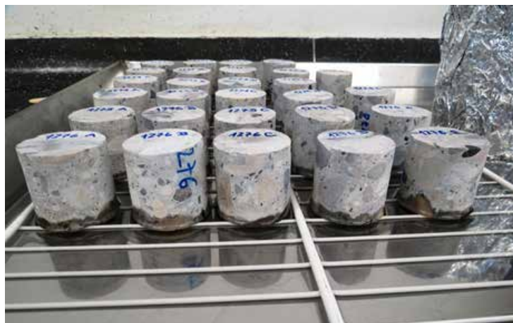
Figura 19. Ensayo de absorción capilar de concreto de acuerdo con la norma SIA 262-Anexo A.
