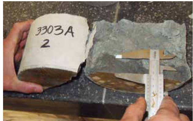
Determinación de la profundidad de penetración de agua.
