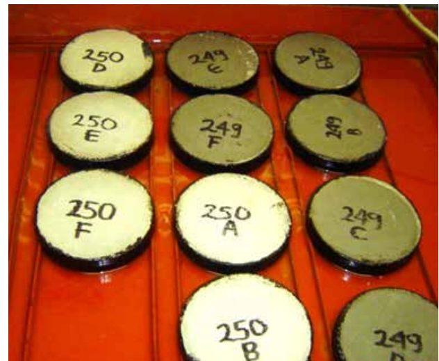
Figura 13. Especímenes de mortero semisumergido con y sin Sika al cabo de 4 horas de absorción capilar.
