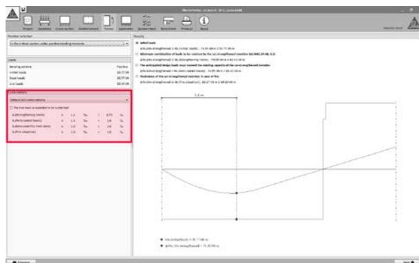
Los factores de combinación de cargas para cada hipótesis se muestran a la izquierda de la pantalla, mostrando por defecto los valores indicados en ACI 318 y ACI 440.2R-08.
