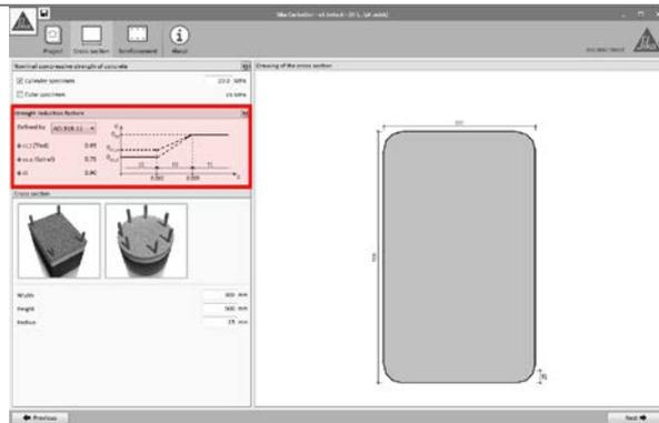
La resistencia de diseño del elemento estará basada en su resistencia nominal de acuerdo a ACI 318 y ACI 440.2R-08, multiplicada por su factor de reducción de resistencia  $\Phi$ .
