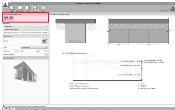
Las posibles disposiciones del refuerzo de FRP se muestran en la esquina superior izquierda de la pantalla.
