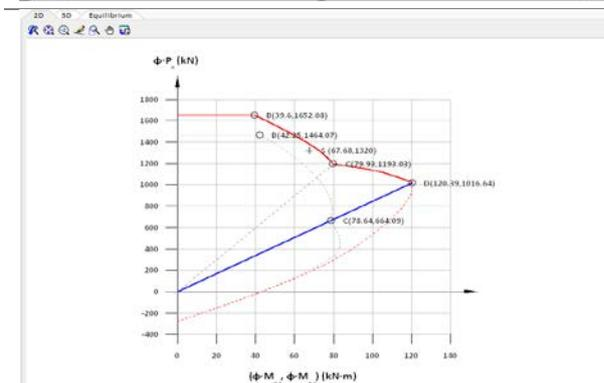
La opción 2D muestra simultáneamente la resistencia última del elemento sin reforzar (punteado) y del elemento reforzado (línea roja), así como las líneas de balanceo y los valores más significativos del diagrama.
