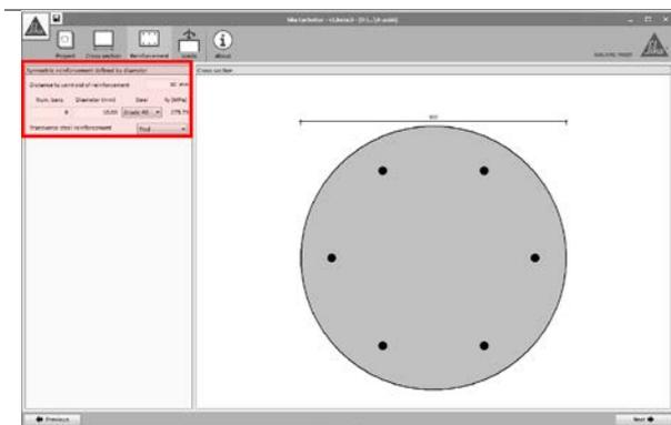
En el caso de columnas circulares, las barras de acero longitudinales se distribuyen homogéneamente alrededor de su perímetro.
