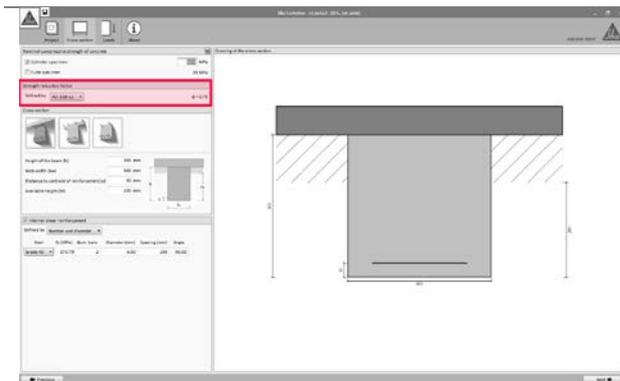
La resistencia de diseño del elemento estará basada en su resistencia nominal de acuerdo a ACI 318 y ACI 440.2R-08, multiplicada por su factor de reducción de resistencia  $\Phi$ .
