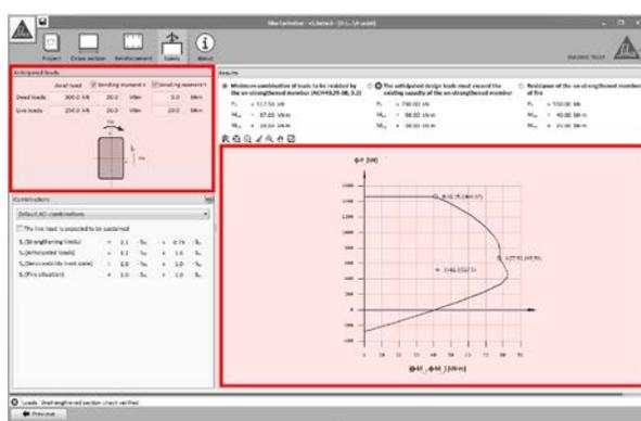
En el caso de combinarse cargas axiales y momentos flectores, el software mostrará diagramas de interacción en 2D, indicando los límites para las distintas situaciones, tal y como se detalla a continuación.
