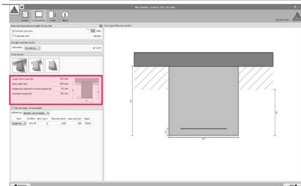
Los principales parámetros de la geometría de la sección se definen a partir de las casillas dispuestas bajo los esquemas de selección. Tenga en cuenta que la altura disponible para la colocación del FRP puede estar restringida como consecuencia de la existencia de revestimientos o paneles bajo la losa o las alas laterales.
