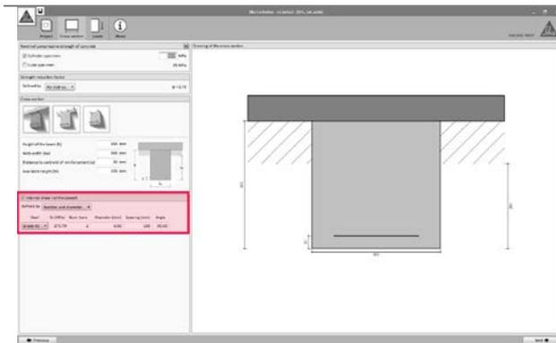
El refuerzo de acero interior puede ser introducido mediante su sección neta o mediante el diámetro, cuantía y separación de los estribos.
