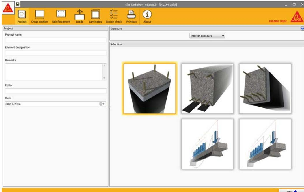
La elección de la tipología de refuerzo a calcular se realiza mediante los esquemas en la pantalla principal:
