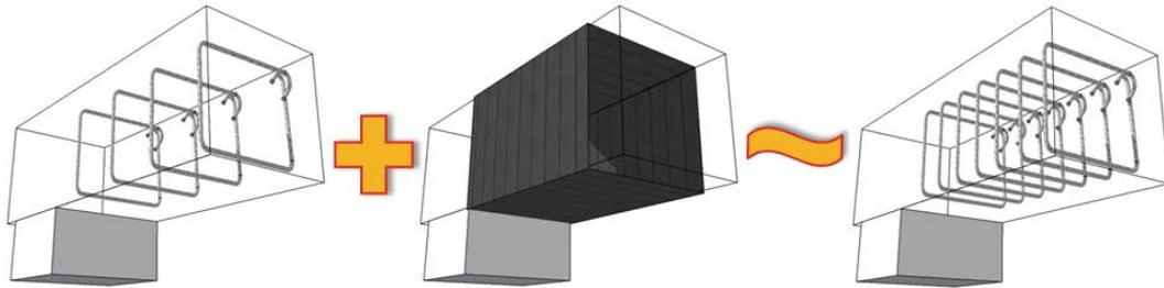
La deformación efectiva dependerá del grado de despegue del FRP cuando la capacidad a cortante del concreto reforzado es sobrepasada; es decir, de su tipología de anclaje (FRP correctamente anclado – como encamisados cerrados- respecto a FRP con limitaciones en su anclaje –como encamisados abiertos-).
