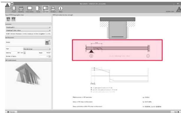
El software determina la disposición necesaria de los laminados FRP de acuerdo a los esfuerzos previstos y la resistencia inicial del elemento.
