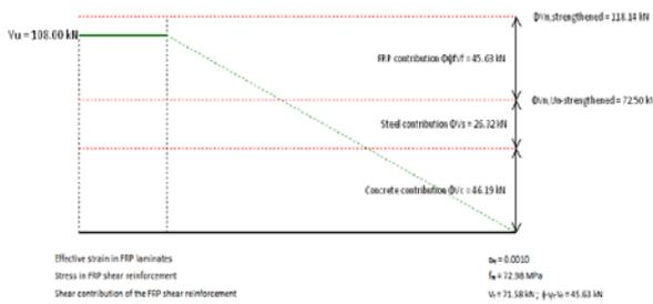
Por último, la contribución a cortante del FRP es mostrado junto a las resistencias aportadas por la sección de concreto y el refuerzo interno de acero.
