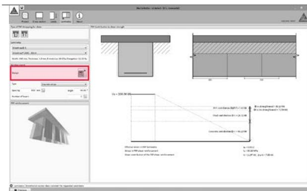
El dimensionado automático (icono con forma de calculadora) tendrá en cuenta la configuración elegida, el tipo de FRP y el espaciado de los laminados (zunchado uniforme o laminados individuales).
