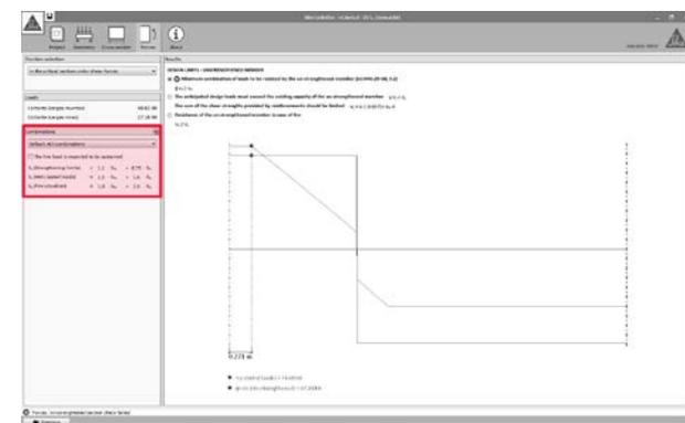
Los factores de combinación de cargas para cada hipótesis se muestran a la izquierda de la pantalla, mostrando por defecto los valores indicados en ACI 318 y ACI 440.2R-08.
