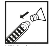
6. Ajustar la espátula plástica en la punta de la boquilla de aplicación para sellar la grieta en el sustrato y entre los puertos de inyección
