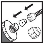
2. Coloque el enchufe de salida del cartucho en la punta del cartucho; posteriormente, colocar la boquilla mezcladora de resina de inyección en el cartucho.
