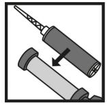
4. Coloque el cartucho de Sikadur® Sellador de Fisuras en la pistola de aplicación lista para usar. Extruir hasta que salga la mezcla con color uniforme gris concreto. No usar material sin mezclarse
