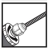
3. Deslizar la tapa del tornillo sobre la boquilla del mezclador de resina de inyección y conéctarlo al cartucho con ese movimiento.
