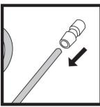
6. Coloque y ajuste el conector Push fit, ajustando a presión en la boquilla del mezclador de resina de inyección. Extruir una cantidad de resina liquida para asegurar una mezcla homogénea e inicie después de eso la inyección en los puertos de inyección.
