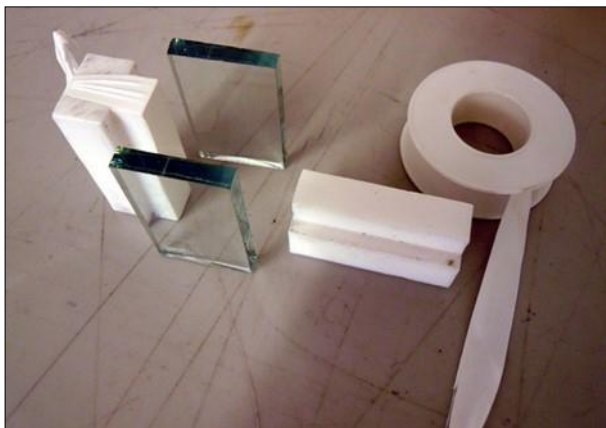
Figura 20: Espaciadores, cinta de e-PTFE (cinta necesaria para 1-componentes adhesivos) y piezas de sustrato (por ejemplo, vidrio).
