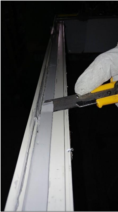
Figura 29: Probando la adherencia de la unión a lo largo de todo el marco - Buena adherencia.
