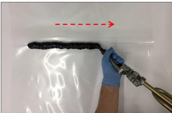
Figura 6: Aplica el cordón en la dirección del pliegue
