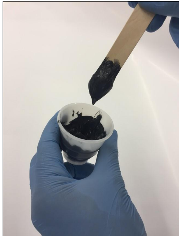
Figura 12: El material muestra un comportamiento parecido al de la goma: el tiempo de formación de piel se ha llegado
