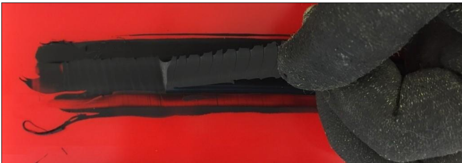
Figura 18: Prueba de Adhesión del cordón: Corte del cordón, ocurriendo una falla cohesiva del 100%
