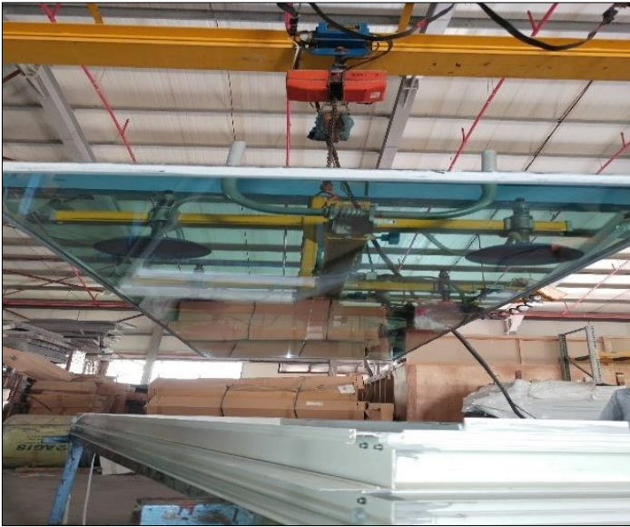
Figura 28: El panel de vidrio se quitó completamente del marco.
