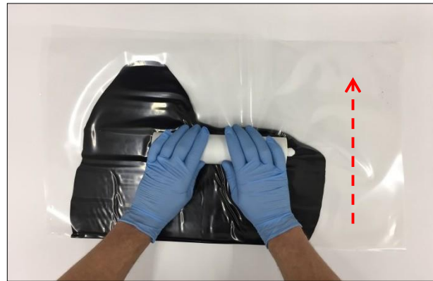
Figura 7: Presiona el cordón sólo en dirección perpendicular al pliegue
