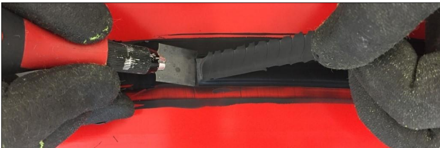
Figura 19: Prueba de adhesión del cordón en vidrio esmaltado: cortar el cordón mientras se tira
