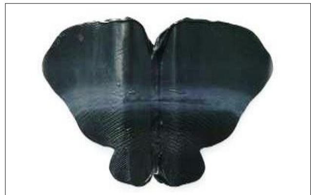
Figura 9: Desplegar el papel de aluminio - Prueba negativa = positiva = mezcla inadecuada
