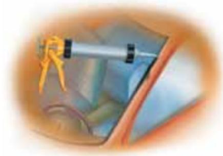
10. Presionar suavemente el vidrio hasta nivelar el área de pegado. Si la adhesión fue realizada con **SikaTack®Drive**, esperar dos horas antes de poner en movimiento el vehículo. Si se usa **Sikaflex®-256** esperar cuatro horas. (Si el carro tiene doble AirBag.)
