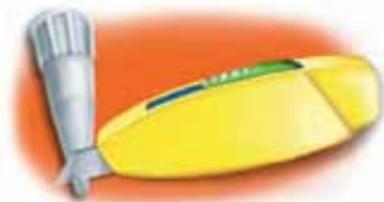
3. Colocar la boquilla verticalmente y realizar un corte en V. El ancho y la altura del corte varía según el modelo del vehículo. "Calcular la altura y la base antes de cortar".
