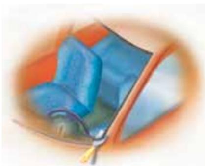
4. Colocar el vidrio sin adhesivo para asegurar que tenga el tamaño y la forma acorde con el marco del carro y marcar los puntos de referencia con cinta de enmascarar para facilitar el ajuste preciso del vidrio.
