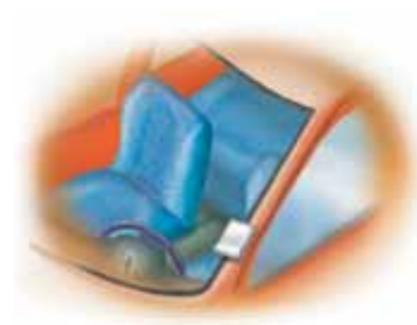
7. Si la carrocería presenta rasguños se debe aplicar **Sika®Primer 206 G+P** para evitar futura corrosión en la pestaña donde irá ubicado el adhesivo. Esperar 20 minutos a que evaporen los solventes.
