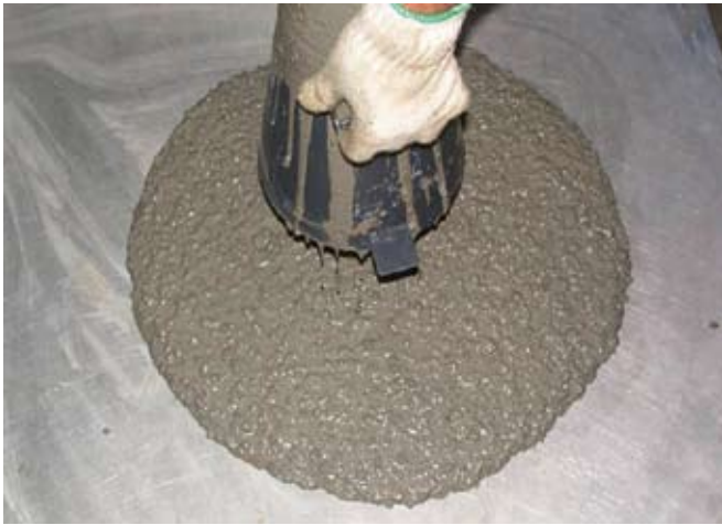
Foto No. 7: Medición del flujo de un concreto autocompactante. Nótese la homogeneidad de la mezcla.
