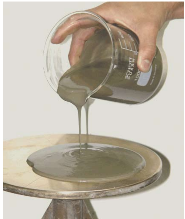
Foto No.1 Pasta de cemento con exceso de agua (lechada)
