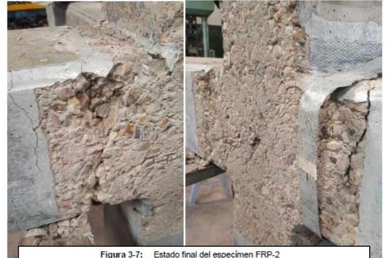
Figura 3-7: Estado final del espécimen FRP-2
