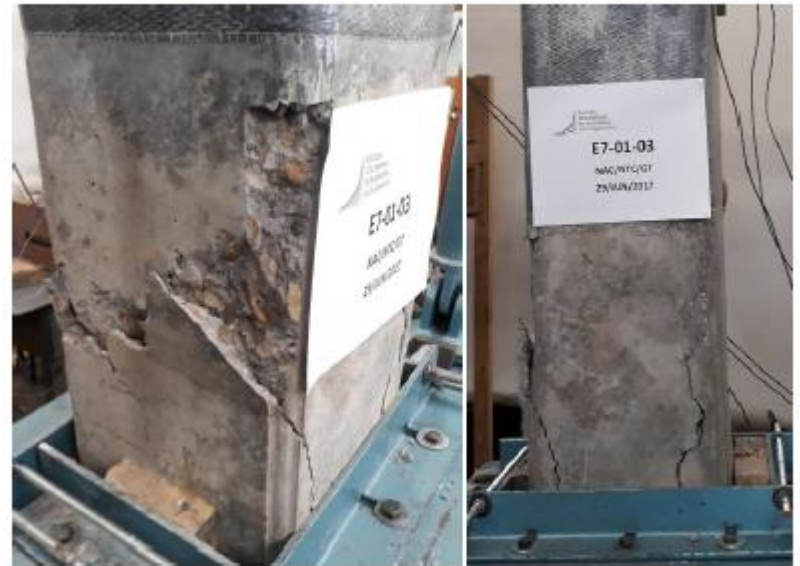
Figura 3-11: Falla localizada en la base de la columna
