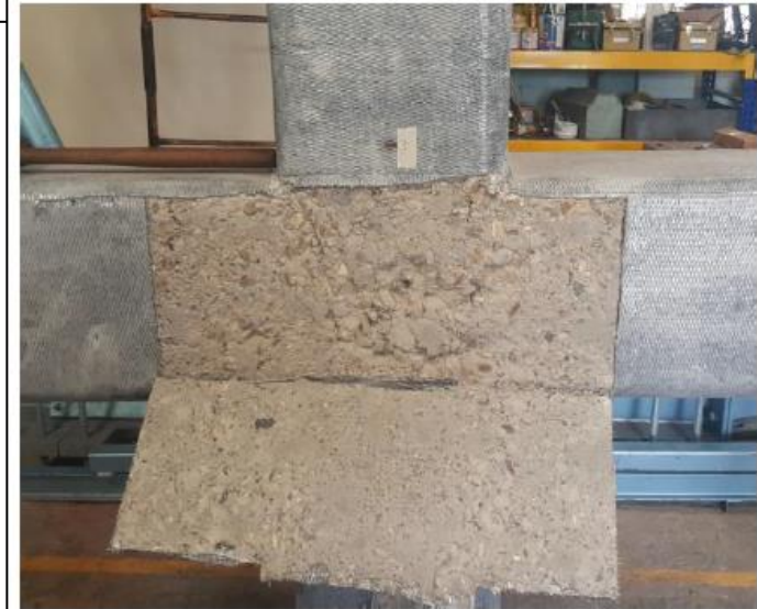
Figura 3-7: Estado final del espécimen FRP-2
