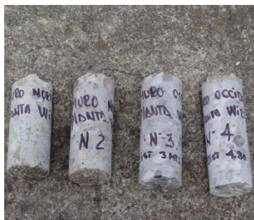
Baja resistencia a compresión del concreto
