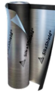
**Sika Manto 4.0 Foil de Aluminio:** Membrana impermeable de 4.0 mm de espesor de asfalto modificado, con refuerzo de polietileno de alta densidad y acabado superior en foil de aluminio de alto calibre y gran expectativa de vida útil.
