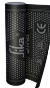
**Sika Manto APP 3.0 Polyester:** Membrana impermeable de 3.0 mm de espesor de asfalto modificado, con refuerzo de poliéster de alto gramaje 180 gramos/m<sup>2</sup> y acabado superior arenado.
