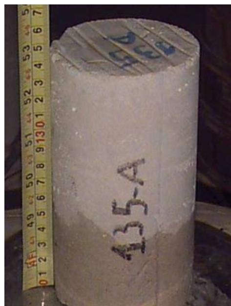
Ensayo de absorción capilar usando un cilindro de concreto.
