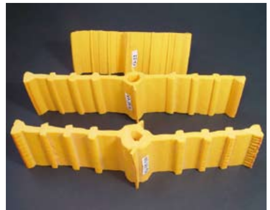
Diferentes tipos de Cinta Sika PVC . La escogencia se hace de acuerdo con el ancho del muro, la presión hidrostática actuante y el movimiento esperado en la junta.
