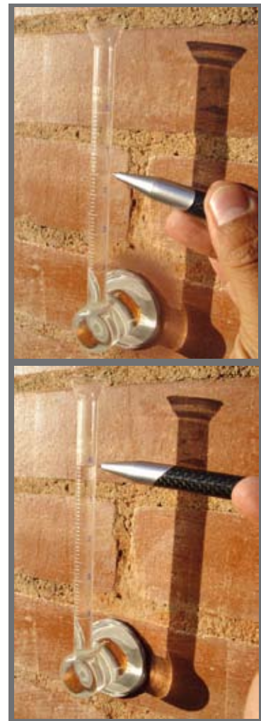
Prueba de absorción de las unidades de mampostería, antes y después de su hidrofugación con un repelente de agua para fachadas, para determinar la eficiencia de la aplicación
