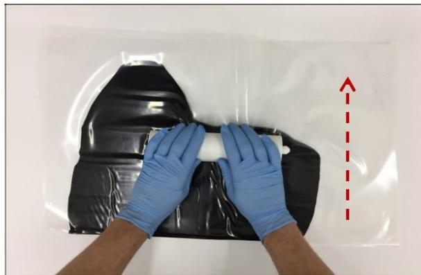
Figura 5: Pulse el cordón sólo en dirección perpendicular al pliegue
