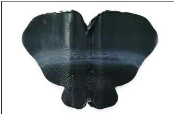
Figura 7: Despliegue la lámina - Prueba negativa = mezcla inadecua
