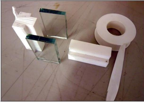
Figura 15: Espaciadores, cinta de e-PTFE (cinta necesaria para adhesivos de 1 componente) y piezas de sustrato (por ejemplo, de vidrio)
