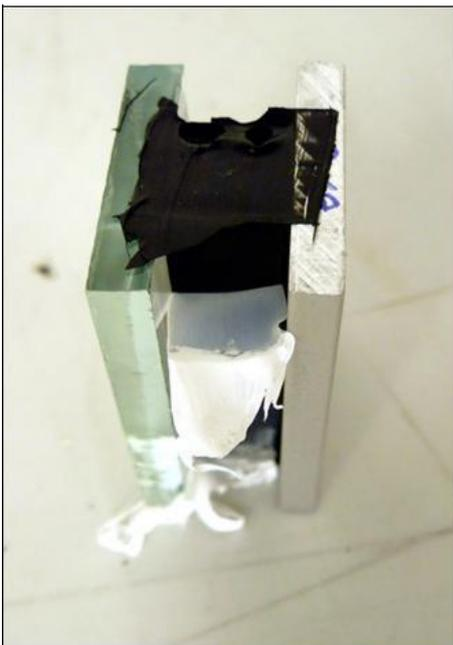
Figura 19: Eliminar Los espaciadores después de 1 día, remove cinta de e-PTFE después de 7 días (1-parte adhesivos).
