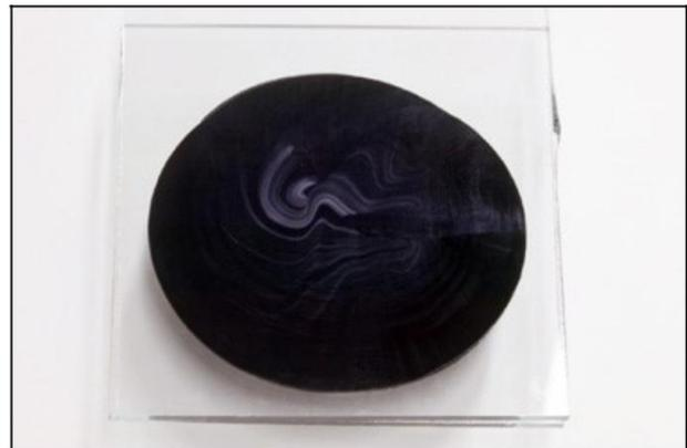
Figura 3: Prueba negativa = mezcla inadecuada
