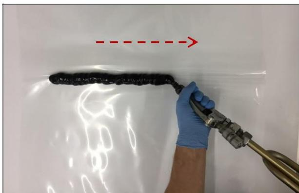
Figura 4: Aplicar el cordón en la dirección del pliegue
