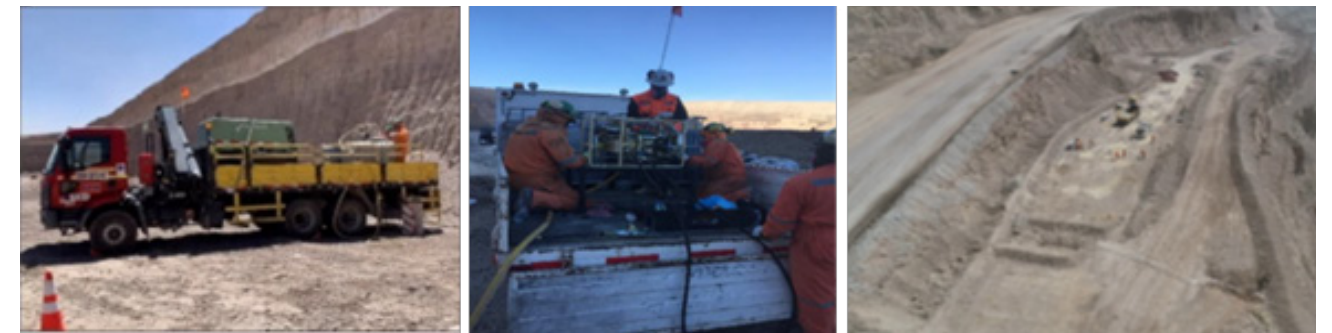
Fotografía 2. Equipos móviles de bombeo de resinas para una aplicación de inyecciones en forma industrial en bancos de minería cielo abierto.
