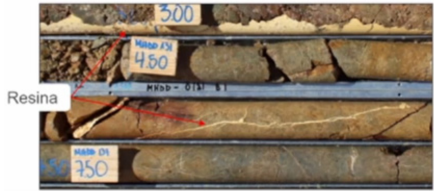
Fotografía 6. Resina tipo SIKAFIX® esparcida a través de las grietas y rellenando con adherencia las fracturas de testigos.
