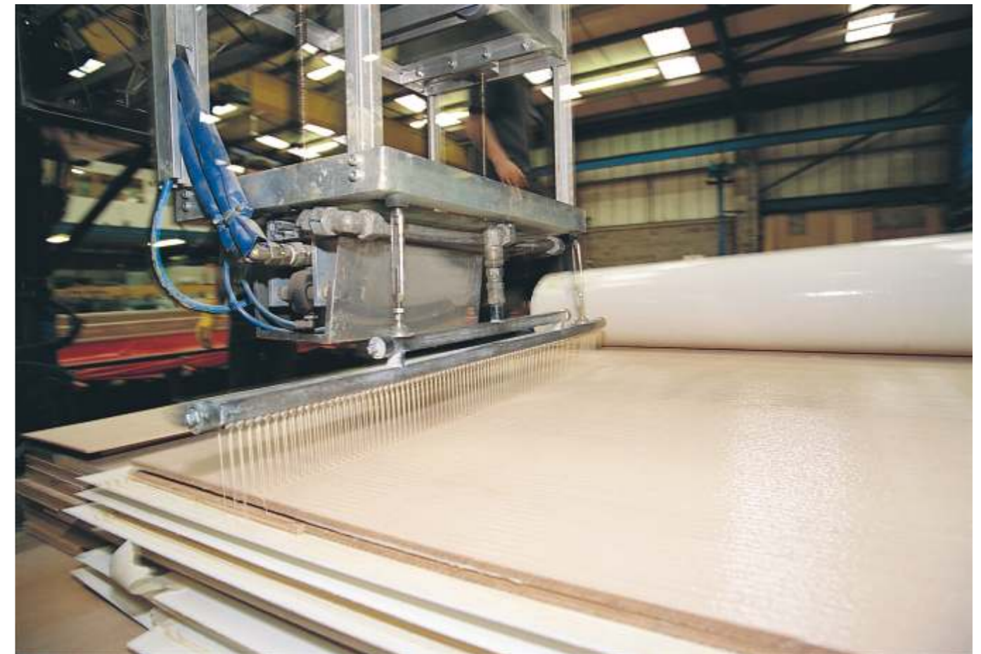
SikaForce® aplicado con barra esparcidora
