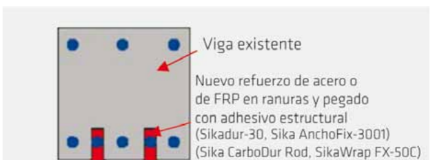
Figura 15. Instalación de varillas de acero o de FRP en ranuras en el reforzamiento de una viga.
