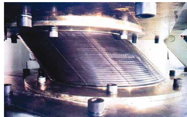
Prueba de aislador (Bridgestone)
