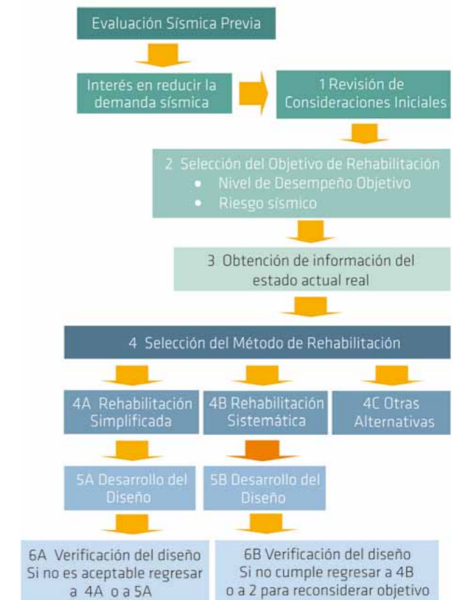
Figura 1. Proceso de rehabilitación según FEMA 356 [4].
