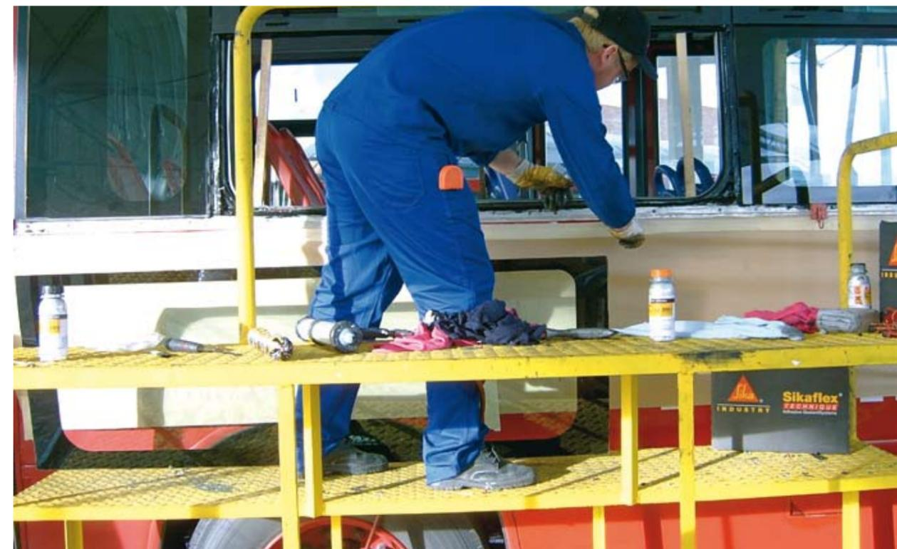
Vidrios laterales pegados a la estructura en acero con Sikaflex 265.
