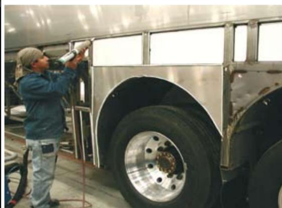
Pegado entre estructura en acero galvanizado y laterales en aluminio.
