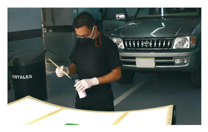
no generan corrosión y su aporte de peso es casi imperceptible. Tienen buenas propiedades de no escurrimiento que pueden ser aplicados en áreas como techos, puertas y pisos. En el evento de un ataque con arma de fuego, la elasticidad de los productos adhesivos en conjunto con estos compuestos trabajarán, para que el proyectil cuando llegue a impactarse sobre el material, reduzca su energía y no pueda seguir penetrando al interior del vehículo, evitando el daño a los pasajeros.
